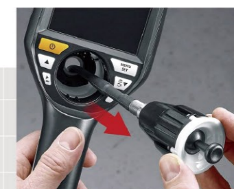
メンテナンスや収納に便利な脱着可能カメラケーブル
